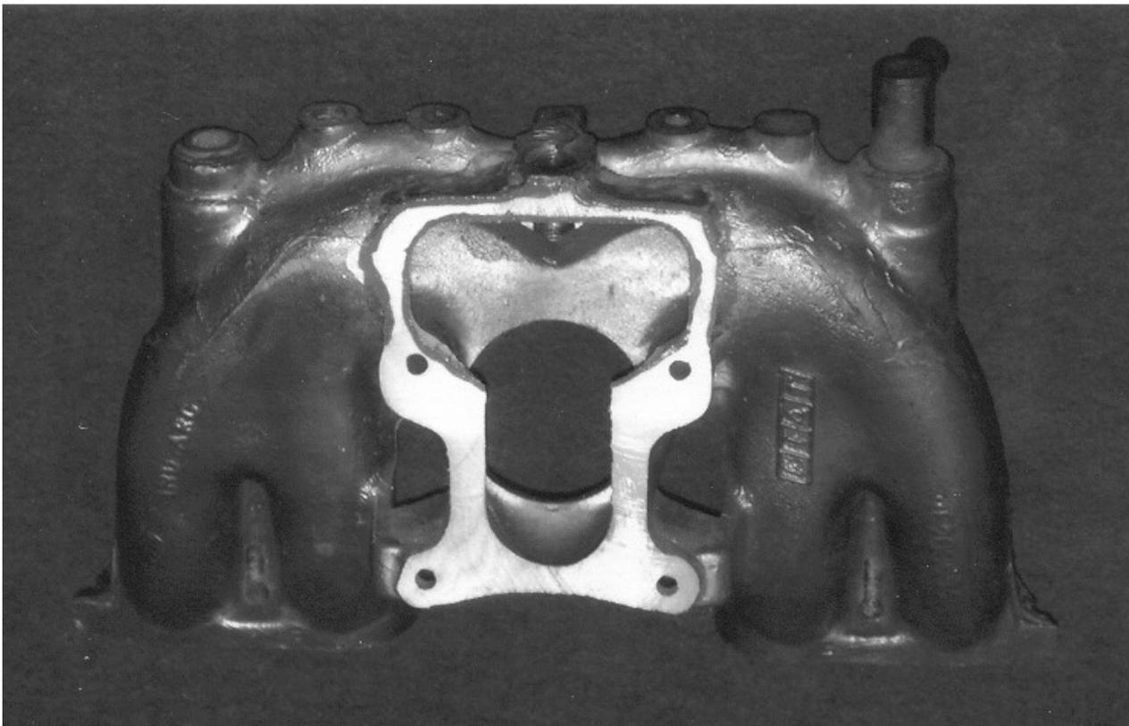
**7.5 Base adaptadora:** Se permite una base adaptadora para instalar el carburador de libre material y diseño, que deberá tener una altura máxima de 33 mm, incluyendo la brida limitadora y junta, desde la base del múltiple a la base del carburador.
